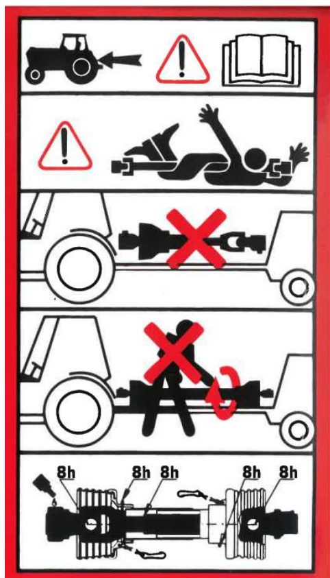
Rys. 2 NALEPKA OSTRZEGAWCZA – 100210/00.00.011 – NA ZEWNĘTRZNEJ RURZE OSŁONY
